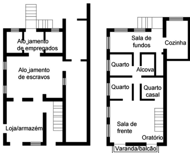
Figura 2 – Esquema de planta baixa de casa em Olinda considerada arquetípica de sobrado colonial (Cf. SMITH, 1981)
